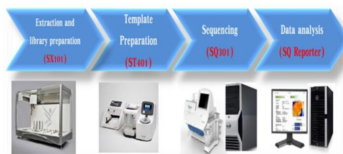
ภาพประกอบ5 : เครื่อง Next generation Sequencing ที่ใช้สำหรับการตรวจ HIV Genotype โดยใช้เทคนิค Next generation Sequencing (Vela Diagnostic) Sentosa ® SQ HIV Genotyping Assay
