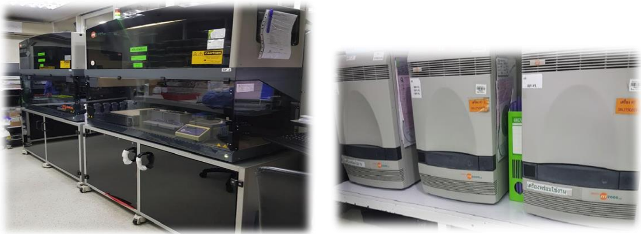
ภาพประกอบ 4 : ภาพเครื่องแยกสกัดสารพันธุกรรมอัตโนมัติ m2000sp และเครื่อง real-time PCR m2000rt ที่ใช้สำหรับการทดสอบ การตรวจวัดปริมาณไวรัสชนิดต่างๆ จากตัวอย่างส่งตรวจเชิงปริมาณ (Quantitative assays for monitoring) เช่น HIV Viral load, HBV Viral load และ HCV Viral load
