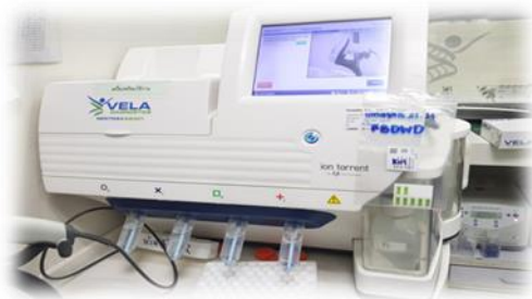
ภาพประกอบ5 : เครื่อง Next generation Sequencing ที่ใช้สำหรับการตรวจ HIV Genotype โดยใช้เทคนิค Next generation Sequencing (Vela Diagnostic) Sentosa ® SQ HIV Genotyping Assay
